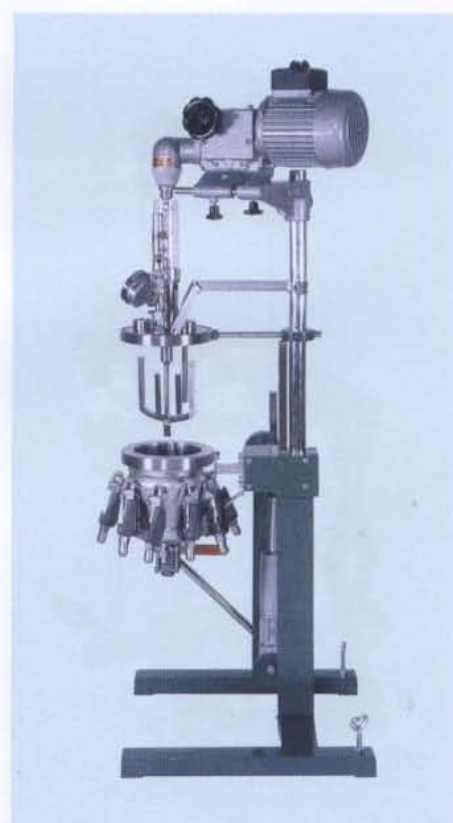
Реактор может быть разобран для чистки
