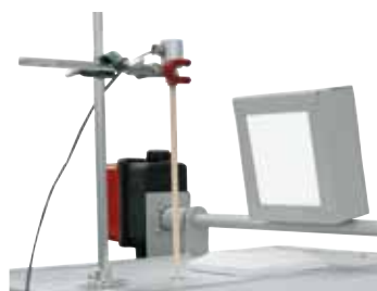
Заслонка отводимого воздуха и термоэлемент загрузки со штативом в качестве дополнительного оборудования
