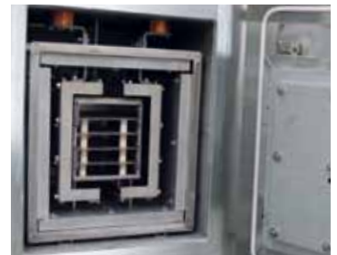
Молибденовый или вольфрамовый нагревательный элемент
