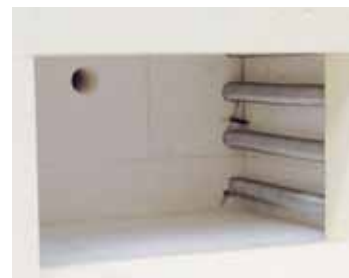
Внутреннее пространство печи с высококачественной изоляцией из огнеупорным легковесным кирпичом
