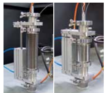
Термоэлемент типа S с автоматическим устройством выдвигания для точного управления в нижнем диапазоне температур
