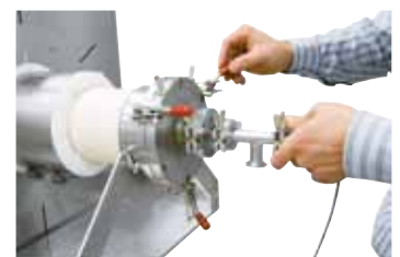
Конечные фланцы с водяным охлаждением с быстродействующими соединительными вставками в качестве дополнительного оснащения
