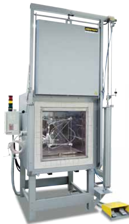
Измерительная рама для определения однородности температуры
