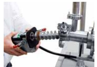
Шнековый транспортер с регулировкой скорости вращения
